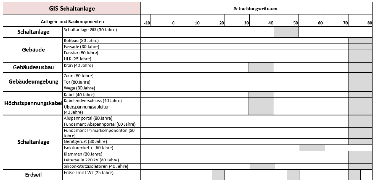
Abbildung 6: Lebensdauer der Anlagekomponenten einer GIS-Schaltanlage, Betrachtungszeitraum 80 Jahre
